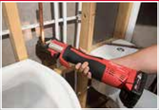
Nejkompaktnější konstrukce in-line
