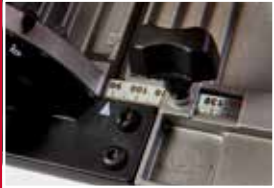
Dvojité uchycení je ukotveno v přední a zadní části pily
