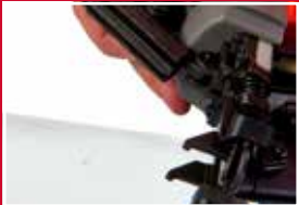
Vyjmutí zaseknutého hřebíku bez použití nářadí
