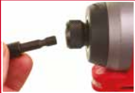
Vložení vrtáku jednou rukou
