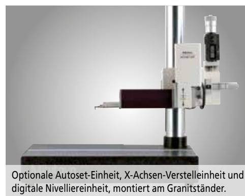
Optionale Autoset-Einheit, X-Achsen-Verstelleinheit und digitale Nivelliereinheit, montiert am Granitständer.
